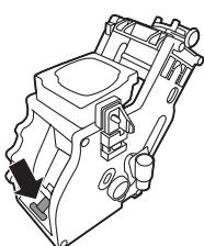
– Для правильной установки фиксатора поднимайте его до крайнего верхнего положения.
