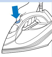
**1** Pulse el botón ECO cuando el aparato esté encendido. El piloto inteligente comienza a parpadear en verde. Cuando la plancha alcanza el modo ECO y está lista para su uso, el piloto inteligente deja de parpadear y se ilumina en verde de forma continua.
