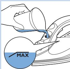
**Προσοχή:** Μην ρίχνετε στη δεξαμενή νερού άρωμα, ξύδι, κόλλα κολλαρίσματος, ουσίες αφαλάτωσης, υγρά σιδερώματος ή άλλα χημικά, καθώς η συσκευή δεν έχει σχεδιαστεί για χρήση με τα χημικά αυτά.
