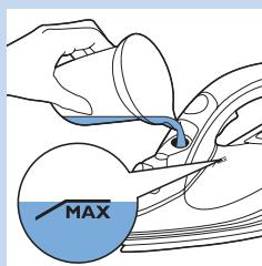
Precaución: No eche en el depósito de agua perfume, vinagre, almidón, productos desincrustantes, productos que ayuden al planchado ni otros productos químicos, ya que el aparato no se ha diseñado para funcionar con estos productos químicos.
