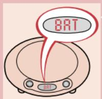
**1** Wymień baterię wówczas, gdy na wyświetlaczu pojawi się napis: "BAT".
