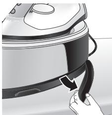
**6** Izvadite crijevo za dovod vode iz odjeljka za spremanje.
