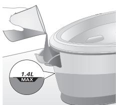
2 Наповніть резервуар водою до позначки MAX, після чого закрійте дверцята резервуара до фіксації ("клацання").
