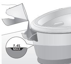
**2** Füllen Sie den Wasserbehälter bis zur MAX-Markierung. Schließen Sie dann die Füllabdeckung, bis sie hörbar einrastet.
