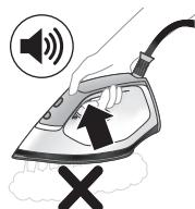
**2** Bundan əlavə, ərdən qorumaq üçün cihaza ikinci bir müdafiə mərhələsi daxil edilmişdir: ərp təmizləmə prosesi aparılmasa, buxar funksiyası söndürülür. Cihaz ərdən təmizləndikdən sonra buxar funksiyası bərpa olunacaq. Bu, istifadə olunan suyun növündən asılı olmayaraq baş verir.
