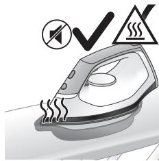
**9** Når afkalkningen er færdig, holder strygejernet op med at bippe, og CALC-CLEAN-indikatoren holder op med at blinke.
