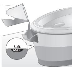
2 向水箱注水至最高水位标示 (MAX)，然后关闭水箱注水门
