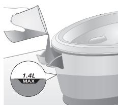
**2** Fyll vannbeholderen opp til MAX-merket og lukk døren for påfylling av vannbeholder (du hører et kikk).
