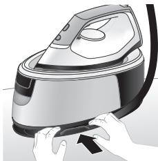
**7** Hajtsa össze a hálózati kábelt, és rögzítse a tépőzáras szalaggal. Ezután két kézzel vigye a készülék alapzatát.
