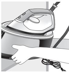
**4** Hajtsa össze a hálózati kábelt, és rögzítse a tépőzáras szalaggal. Ezután két kézzel vigye a készülék alapzatát.
