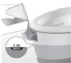
**2** Encha o depósito da água até à indicação MAX. Em seguida, feche a abertura de enchimento do depósito de água (ouve-se um estalido).
