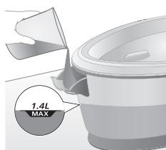
**2** Remplissez le réservoir d'eau jusqu'à l'indication MAX. Fermez ensuite l'ouverture de remplissage du réservoir d'eau (« clic »).
