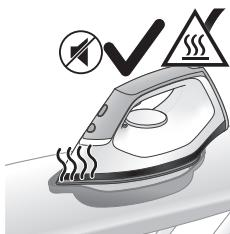
10 เมื่อกระบวนการขจัดคราบตะกรันเสร็จสมบูรณ์แล้ว เตาเรดจะหยุดส่งเสียงบีบและไฟสัญญาณขจัดคราบตะกรันจะดับลง ข้อควรระวัง: เตาเรดร้อน
