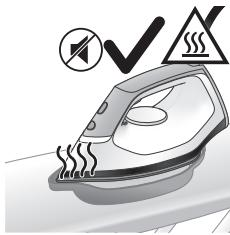
**10** När avkalkningsprocessen är slutförd slutar strykjärnet att pipa och avkalkningslampan slutar att blinka.
