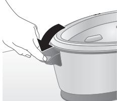
**2** Tölts fel a víztartályt a MAX jelzésig, majd zárja be a víztartály töltőajtaját („kattanó” hang hallható).
