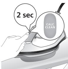
**8** Pritisnite gumb CALC-CLEAN i zadržite ga 2 sekunde dok ne začujete kratke zvučne signale.
