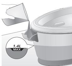
2 Заполните резервуар для воды до отметки максимального уровня (MAX). Закройте крышку наливного отверстия (должен прозвучать щелчок).
