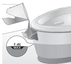
**2** Наполнете го резервоарот за вода до ознаката MAX, а потоа затворете ја вратичката за полнење на резервоарот за вода („клика“).
