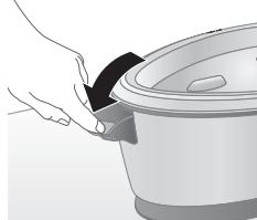
**2** Γεμίστε το δοχείο νερού μέχρι την ένδειξη MAX και κλείστε τη θύρα γεμίσματος του δοχείου νερού ("κλικ").
