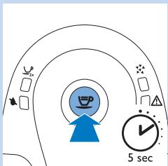
Bemærk: Hvis du vil afbryde udstrømningen af afkalkningsopløsning, skal du trykke på kaffebrygningsknappen. Tryk på kaffebrygningsknappen igen for at genstarte udstrømningen af afkalkningsopløsning.
