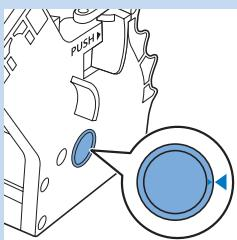
**7** Προτού τοποθετήσετε τη μονάδα παρασκευής στη μηχανή, βεβαιωθείτε ότι οι δύο ενδείξεις αναφοράς στο πλάι ταιριάζουν. Αν δεν ταιριάζουν, κάντε το εξής:
