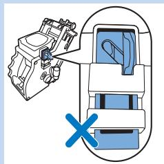
Bemærk: Krogen sidder ikke korrekt, hvis den stadig er i nederste position.
