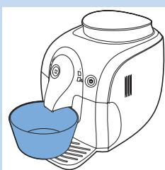
Laitteen alkulämmityksen aikana puhdasta vettä virtaa kahviin läpi ja lämmittää sen. Tämä kestää muutaman sekunnin.
