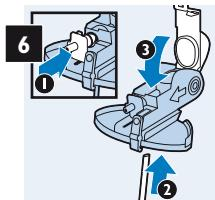
Duw de stoominlaat terug in het deksel, bevestig de melkbuis stevig aan het koppelstuk van het melkreservoirdeksel en sluit het klepje van melkreservoirdeksel.
