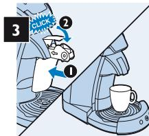
Réinsérez le réservoir de lait et placez une tasse vide sur le repose-tasses.
