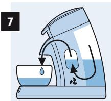
A víztartályban lévő víz a készüléken keresztül a forralóba kerül. Ez a folyamat automatikusan leáll, ne szakítsa meg!
