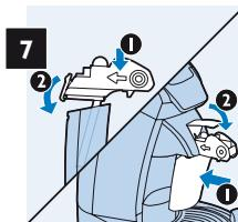
Bevestig het deksel weer, plaatst de melkreservoirunit in de machine en druk de hendel omlaag.
