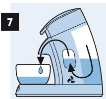
Het water in het waterreservoir wordt door de machine gespoeld en de boiler wordt met water gevuld. Dit proces stopt automatisch, onderbreek het niet.
