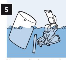
Nettoyez le réservoir de lait, son couvercle et le bec d'admission de lait au lave-vaisselle (recommandé) ou à l'eau chaude additionnée d'un peu de produit vaisselle. Rincez les éléments à l'eau froide une fois nettoyés.
