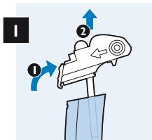
Retirez le couvercle du réservoir de lait.
