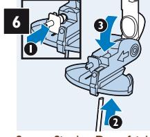
Setzen Sie den Dampfeinlass wieder ein, stecken Sie den Milchschlauch fest auf den Anschluss des Milchbehälterdeckels, und schließen Sie die Abdeckung des Milchbehälterdeckels.
