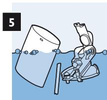
Maak het melkreservoir, het melkreservoirdeksel en de melkbuis in de afwasmachine schoon (aanbevolen) of in warm water met afwasmiddel. Spoel de onderdelen na het schoonmaken met schoon water.
