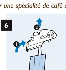
Retirez le couvercle du réservoir de lait.
