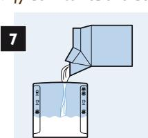
Fyld mælkeholderen med kold mælk (5-8°C) til det korrekte niveau.
