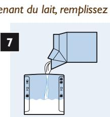
Remplissez le réservoir de lait avec du lait froid jusqu'au niveau approprié (5-8 °C).
