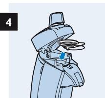
Zorg ervoor dat er een padhouder zonder pad(s) in de machine is geplaatst.
