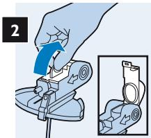
Ouvrez le capot du réservoir de lait.
