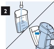
Füllen Sie den Wasserbehälter mit Wasser, und setzen Sie ihn zurück in die Maschine.
