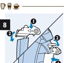
Helyezze vissza a fedelmet és helyezze be a tejtartó egységet a géphez, és nyomja le a kart.
