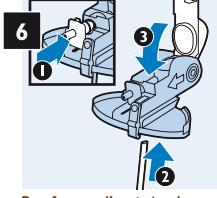
Renfoncez l'arrivée de vapeur, fixez fermement le bec d'admission de lait sur le raccord du couvercle du réservoir de lait, puis fermez le capot.
