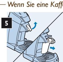
Klappen Sie den Verschlusshebel nach oben, und nehmen Sie die Milchbehälter-Einheit aus der Maschine.
