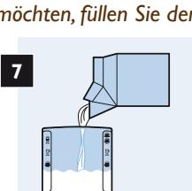
Füllen Sie den Milchbehälter mit Milch (5 bis 8 °C) bis zur erforderlichen Füllmenge.
