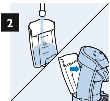
Fyll vannbeholderen med vann, og sett den tilbake på maskinen.
