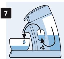
Das Wasser im Wasserbehälter wird durch die Kaffeemaschine gespült und der Boiler mit Wasser gefüllt. Dieser Vorgang stoppt automatisch, unterbrechen Sie ihn daher nicht!
