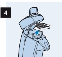
Vergewissern Sie sich, dass sich ein Padhalter ohne Pads in der Maschine befindet.
