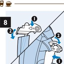
Bevestig het deksel weer, plaatst de melkreservoirunit in de machine en druk de hendel omlaag.
