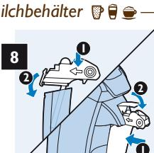
Befestigen Sie den Deckel, setzen Sie die Milchbehälter-Einheit wieder in die Maschine ein, und drücken Sie den Hebel nach unten.
