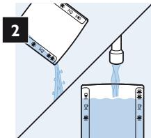
Rincez le réservoir de lait sous le robinet et remplissez-le d'eau froide.
