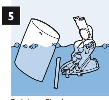
Reinigen Sie den Milchbehälter, den Milchbehälterdeckel und den Milchschlauch in der Geschirrspülmaschine (empfohlen) oder in heißem Wasser mit etwas Spülmittel. Spülen Sie die einzelnen Teile mit frischem Wasser nach.
