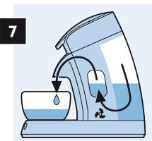
Vannet i vannbeholderen kjøres gjennom maskinen, og kokeren fylles med vann. Denne prosessen stopper automatisk. Du må ikke avbryte den.
