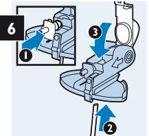
Tolja hátra a gózkart, csatlakoztassa biztosan a tejfelszívő tömlőt a tejtartó fedelének csatlakozásához, és csukja le a fedél zároelemét.
