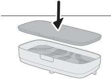
4 مخزن آب را روی شیار بالای دستگاه قرار دهید و برای اطمینان از محکم بودن آن فشار دهید. اگر مخزن آب به درستی قرار نگیرد، آب به سمت مولد بخار جریان نمی یابد این باعث می شود که آیکن «بدون آب» چشمک بزند و ممکن است صداهای عجیبی از فن و موتور ایجاد شود در این صورت، ممکن است عملکرد steam&airfry غیرفعال شود
