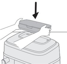
如果水箱未放好，水将无法流入蒸汽发生器。这将会导致“无水”图标
