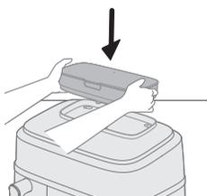
如果水箱未放好，水将无法流入蒸汽发生器。这将会导致“无水”图标
