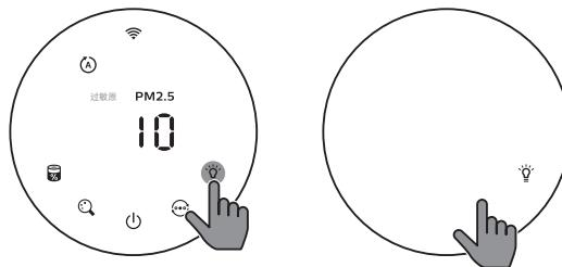
您可以手动轻触灯光开/关按钮 来关闭所有指示灯和控制面板。轻触任何按钮来唤醒所有指示灯。
