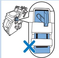
*Remarque : Le crochet n'est pas correctement placé s'il est toujours dans la position la plus basse.*
