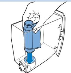
**4** Placez le filtre dans le réservoir d'eau vide. Appuyez dessus jusqu'à ce qu'il ne puisse plus bouger.
