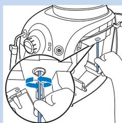
**5** Limpe cuidadosamente o tubo de saída de café com o cabo de uma colher ou outro utensílio de cozinha com uma ponta arredondada.
