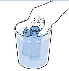
**2** Enlevez le filtre de son emballage et plongez-le dans l'eau froide avec l'ouverture orientée vers le haut. Appuyez légèrement sur les côtés du filtre pour faire sortir les bulles d'air.
