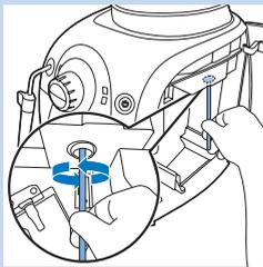
**5** Limpie el conducto de salida del café en profundidad, ya sea con el mango de una cuchara o con cualquier otro utensilio de cocina con la punta redonda.
