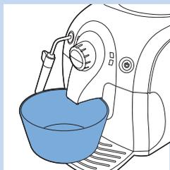
Pendant le cycle de rinçage manuel, la machine prépare une tasse de café pour préparer le circuit interne à l'utilisation.
