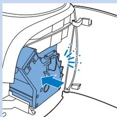
**9** Deslice la unidad de preparación del café en el aparato a lo largo de las ranuras de guía de los laterales hasta que encaje en su posición.
