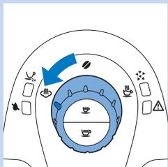
**5** Mergulhe o bocal de água quente/vapor ou o acessório para espuma de leite clássico no leite e rode o botão de controlo para o ícone de vapor. Prepare a espuma de leite rodando suavemente o jarro e movendo-o para cima e para baixo.
