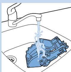
**6** Enxágüe a parte exterior da unidade de preparação em água corrente t pida.
