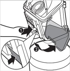
**4** Håll dammbehållaren över en papperskorg och tryck ned kåpans spärr (1) för att öppna dammbehållarens nedre kåpa (2).
