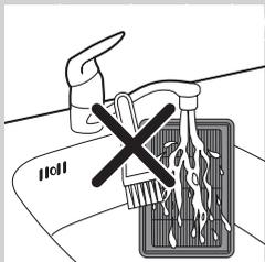
Reinigen Sie den HEPA-Filter niemals mit einer Bürste.
