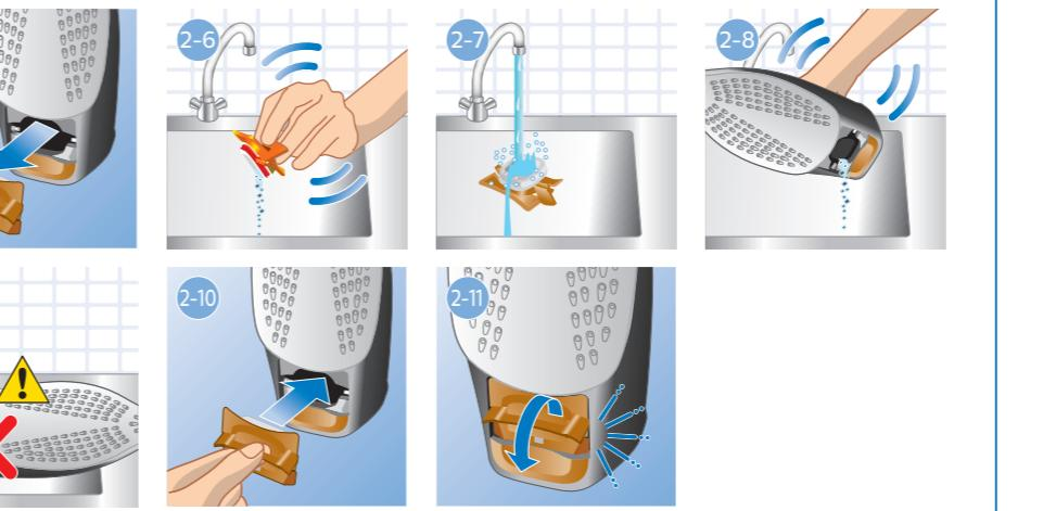
EN Calc-Clean (specific types only) DE Calc-Clean (nur bestimmte Gerätetypen) FR Fonction anticalcaire
