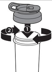
**8** Pričvrstite poklopac okretanjem u smjeru kazaljke na satu.
