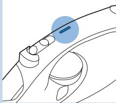
De veilige automatische uitschakelfunctie schakelt het strijkijzer automatisch uit wanneer het langer dan 30 seconden niet wordt gebruikt terwijl het op de zoolplaat staat of langer dan 8 minuten niet wordt gebruikt terwijl het op de achterplaat staat. Het lampje voor de automatische uitschakelfunctie gaat branden.
