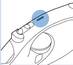
La fonction d'arrêt automatique éteint le fer s'il n'a pas été utilisé pendant 30 secondes et posé sur sa semelle ou pendant 8 minutes et posé sur son talon. Le voyant d'arrêt automatique s'allume.
