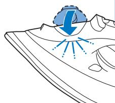
Doe geen reukstof, azijn, stijfsel, ontkalkers, strijkconcentraat of andere chemicaliën in het waterreservoir.
