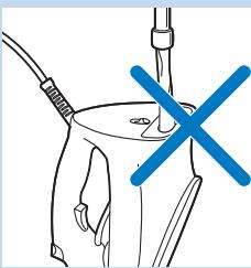
Gießen Sie weder Wasser, Essig, Entkalkungsmittel noch andere Chemikalien in die Quick Calc Release-Öffnung.
