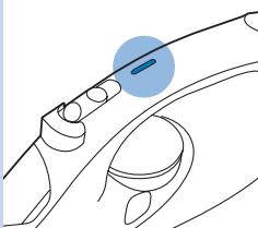
Mit der Funktion zur automatischen Sicherheitsabschaltung wird Ihr Bügeleisen automatisch ausgeschaltet, wenn es 30 Sekunden lang auf der Bügelsohle oder 8 Minuten lang in aufrechter Position abgestellt wurde. Die Anzeige für die automatische Sicherheitsabschaltung leuchtet auf.
