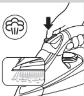
khó ủi. Chức năng tăng cường hơi nước giúp phân phôi đều hơi nước vào mọi chỗ của quần áo. Chức năng tăng cường hơi nước chỉ có thể sử dụng ở nhiệt độ giữa ●●● và MAX.
