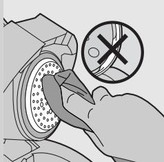
**11** Reinigen Sie den Sprühkopf mit einem feuchten Tuch.
