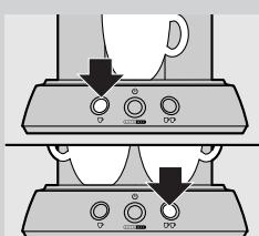
Wenn die Tassen am Ende eines Brühvorgangs nur halb voll sind, war nicht genügend Wasser für zwei Tassen im Wasserbehälter. Für zwei volle Tassen füllen Sie den Wasserbehälter auf, und drücken Sie die 1-Tasse-Taste Ø. Beide Tassen werden dann nachgefüllt.
