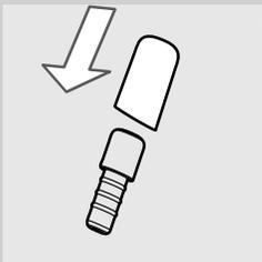
**26** Introducir la protección de goma en el recubrimiento cromado (sólo para Montador de leche Automático con recubrimiento cromado).
