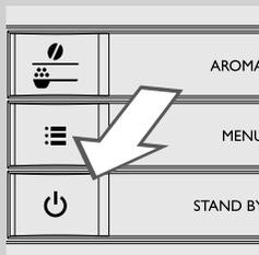
**1** Apagar la máquina pulsando el botón “☺”. Esperar a que el botón “☺” comience a parpadear y desconectar el enchufe del cable de alimentación.
