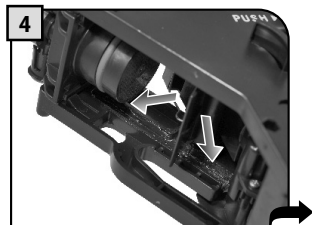
4 Das Fett gleichmäßig auf die zwei seitlichen Führungen verteilen.
