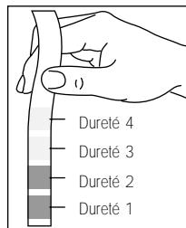
**Dureté 1** (très douce)**Dureté 2** (douce)**Dureté 3** (moyenne)**Dureté 4** (dure)**Réglage de la plaque chauffante**
