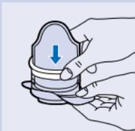
**3** Zajišťovací kroužek vložte na jeho původní místo abyste prachový sáček upevnili.
