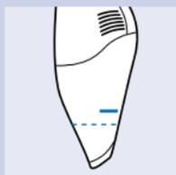
**8** Nu mai aspirați lichide când nivelul de lichide din interiorul compartimentului de praf a ajuns la gradația maximă.
