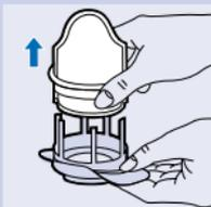
**1** Przesuń do góry obręcz podtrzymującą krawędź worka i wyjmij stary worek.
