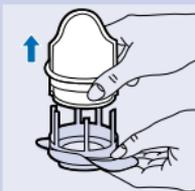
**1** Приподняв мешок-пылесборник за кромку, сдвиньте кольцо вверх и выньте мешок-пылесборник.
