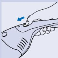
■ Поставте повзунковий вимикач у положення I для нормальної потужності всмоктування. Поставте його у положення II для підвищеної потужності всмоктування (режим "Турбо").
