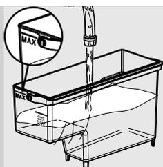
**5** Ополосните бак для воды свежей водой.
