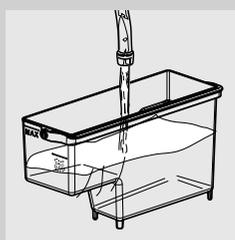
**12** Извлеките бак для воды, ополосните и наполните его свежей водой до указателя уровня MAX. Вставьте его обратно в машину. Когда в машину устанавливается бак для воды, отображается следующий символ.
