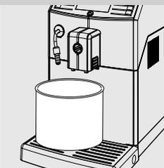
**8** Подставьте вместительную емкость (1,5 л) под трубку пара / горячей воды и под устройство подачи.
