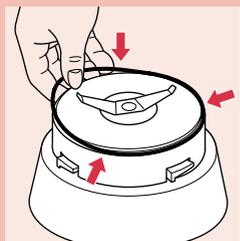
**2** 將塑膠墊圈置於旋轉刀座上。
