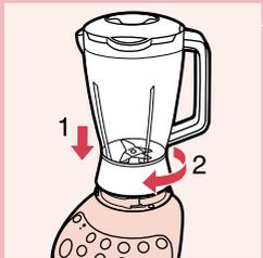
**3** Pasangkan unit balang pada unit motor. Putarkannya mengikut anak panah sehingga kedengaran bunyi klik.
