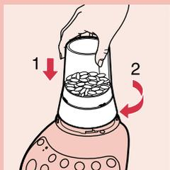
**4** 將組裝好的研磨機倒反過來，並根據箭頭方向將它旋緊在馬達座上。
