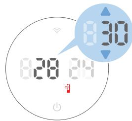
**Sildīšanas** funkcijas darbības laikā nospiediet pogu  $\triangle/\nabla$ , lai pielāgotu temperatūru diapazonā no 1 °C līdz 37 °C.
