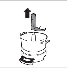
**1** Retire el agitador del cono en la olla.
