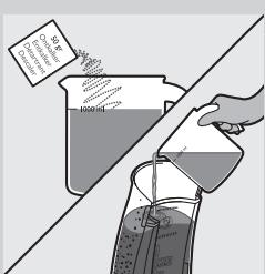
**2** Mischen Sie 50 Gramm Zitronensäure mit 1 Liter Wasser. Füllen Sie den Wasserbehälter mit der Entkalkermischung. Rühren Sie die Flüssigkeit um, bis sich das Pulver vollständig aufgelöst hat.
