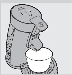
**6** Drücken Sie gleichzeitig kurz die 1-Tasse-Taste ☷ und die 2-Tassen-Taste ☷, um das Entkalken zu starten.
