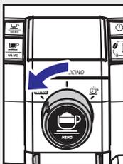
Lai piekļūtu programmēšanas izvēlei, grieziet izvēles slēdzi pretēji pulksteņa rādītāju virzienam uz pozīciju **MENU**.
