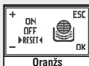
**i** **Piezīme:** Kad 'Intenza' filtrs ir jāmaina, šī funkcija jāpārstata. Nomainiet filtru tāpat kā iepriekš izskaidrots. Pēc tam atveriet programmēšanas izvēlni, līdz tiek parādīta šī izvēlne un izvēlieties iespēju 'RESET' (Pārstaīt); tad spiediet taustiņu
