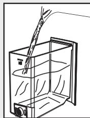
• Ielejiet visu Saeco koncentrētā atkaļķošanas līdzekļa ūdens tvertnē, tad piepildiet tvertni ar svaigu dzeramo ūdeni līdz maksimālajam līmenim. Ievietojiet tvertni atpakaļ ierīcē.
