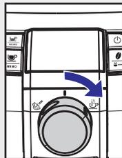
• Tikai tad, kad atkaļķošanas līdzeklis ir ieliets ūdens tvertnē, pagrieziet izvēles slēdži pulksteņa rādītāju virzienā uz pozīciju 'Meln', lai sāktu atkaļķošanas ciklu.
