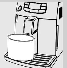
8 Einen großen Behälter (1,5 l) unter die Dampf-/Heißwasserdüse und unter den Auslauf stellen.
