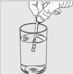
**1** Doppa ned provremsan för test av vattenhårddheten, som medföljer maskinen, i vattnet i 1 sekund.
