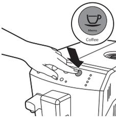
**6** Raz stlačte tlačidlo HOT WATER/MILK CLEAN (ČISTENIE SYSTÉMU NA HORÚCU VODU/MLIEKO). Zariadenie začne dávkovať vodu.
