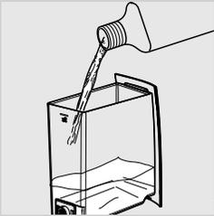
**6** Estrarre il serbatoio dell'acqua e versarvi l'intero contenuto del decalcificante Saeco. Riempire il serbatoio con acqua fresca fino al livello MAX.
