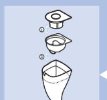
ตรวจสอบให้แน่ใจว่าได้ประกอบแผ่นกันฝุ่น และที่กรองเข้ากับช่องเก็บฝุ่นก่อนที่จะใช้เครื่องดูดฝุ่น หรือของเหลว
