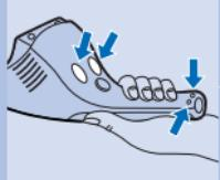
**1** Laissez l'appareil fonctionner jusqu'à l'arrêt complet, défaites les vis et ouvrez l'aspirateur.
