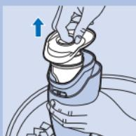
**2** ถอดที่กรอง และแผ่นยางเบนฝุ่นผงออกจากข่องเก็บฝุ่น
