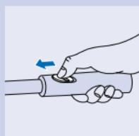
► 您可以使用長管上的滑動開關控制此吸塵器。
