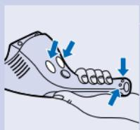
**1** 讓吸塵器運轉直到它停止為止，旋下螺絲並拆開吸塵器。
