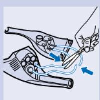
**2** 將連接電線逐條切斷並取下電池。
