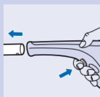
**2** 拔下長管時，請壓下吸塵器把手下方的釋放扭，並將長管拉出吸塵器。
