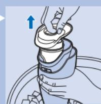
فیلتر را با یک برس یا در صورتی که فیلتر بسیار کثیف باشد با یک جاروی مکشی معمولی تمیز کنید.
