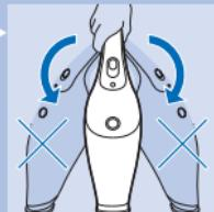
محفظه گرد و غبار دستگاه را رو به بالا قرار ندهید چون این کار منجر به ورود مایعات به درون دستگاه شده و به قطعات داخلی دستگاه صدمه می رساند.
