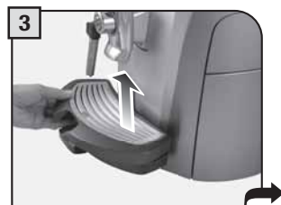
3 Extraer la bandeja de goteo, vaciarla y lavarla.
