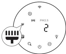
螢幕顯示清潔濾網提示
