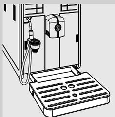
Для выполнения цикла очистки от накипи следуйте инструкциям, приведенным ниже:
