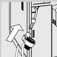
**27** Наденьте автоматический вспениватель молока на защитную резиновую накладку, чтобы он защелкнулся в правильном положении.
