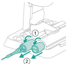
**23** Tournez les brosses en microfibre dans le sens inverse des aiguilles d'une montre (1) et retirez-les de la brosse AquaSpin (2).
