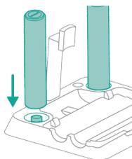
**24** Pour permettre aux brosses en microfibre de sécher, placez les extrémités ouvertes des brosses sur les supports prévus à cet effet sur la station de rangement post-nettoyage.
