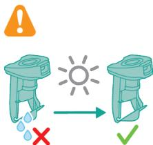
21 Așezați filtrul ud înapoi în rezervorul de apă murdară.
