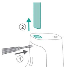
**2** Trekk håndtaket ut av apparatet mens du fortsetter å skyve skrutrekkeren inn i hullet.
