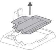
2 Skölj efterrengöringsbrickan under kranen och låt den torka innan du sätter tillbaka den i förvaringsstationen.
