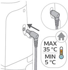
12 Chargez l'appareil. Insérez la fiche d'alimentation dans la prise située à l'arrière de l'appareil. Puis, branchez l'adaptateur sur la prise secteur.
