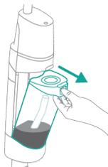
**15** Pritisnite gumb, da odklenete zbiralnik za umazano vodo in ga odstranite.
