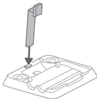
Aby korzystać z funkcji AUTOCLEAN lub ładować i przechowywać urządzenie na stacji do umieszczenia po czyszczeniu i do przechowywania, należy ją najpierw zmontować, wsuwając uchwyt urządzenia w podstawę.
