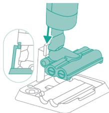
**2** Aparat shranite tako, da ga postavite na postajo za po čiščenju in za shranjevanje. Aparat potisnite na nosilec aparata tako, da konec nosilca aparata obstane v aparatu.
