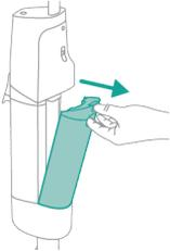
**1** Poussez le bouton vers le bas pour déverrouiller le réservoir d'eau propre et le retirer.
