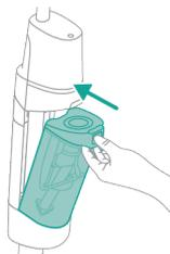
**22** Remplacez le réservoir d'eau sale sur l'appareil.
