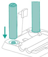
**24** Ščetki iz mikrovlagen se morata posušiti, zato odprta konca ščetk postavite na za to namenjeni držali na postaji za po čiščenju in za shranjevanje.
