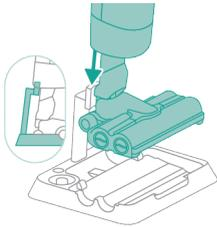
**2** Voit säilyttää laitetta asettamalla sen After-Clean- ja säilytystelineeseen. Liu'uta laite laitetelineeseen niin, että laitetelineen pää työntyy laitteen sisään.
