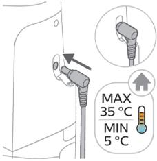
**12** Caricate l'apparecchio. Inserite la spina di alimentazione nella presa situata sul retro dell'apparecchio. Quindi inserite l'adattatore nella presa a muro.
