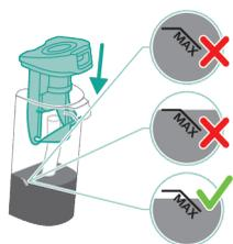
**i** Napomena: Ispraznite prljavi rezervoar za vodu ako je nivo vode iznad oznake AUTOCLEAN. U suprotnom možete preskočiti sledeće korake i preći na korak 6.
