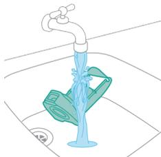
20 Lăsați filtrul umed al rezervorului de apă murdară și elementul său de curgere a apei să se usuce complet înainte de a le pune înapoi în rezervorul de apă murdară.
