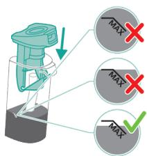
**i** Napomena: ako je razina vode iznad oznake AUTOCLEAN, ispraznite spremnik s prljavom vodom. U suprotnom možete preskočiti sljedeće korake i prijeći na 6. korak.
