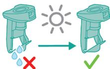
**21** Riposizionate il filtro a umido nel serbatoio dell'acqua sporca.
