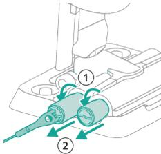
**Tip:** Als een microvezelborstel moeilijk te verwijderen is, kunt u de handgreep van de reinigingsborstel gebruiken om de microvezelborstel te ontgrendelen.
