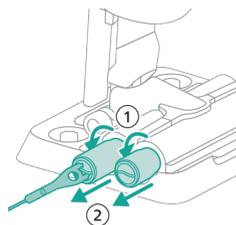
**23** Ščetki iz mikrovlagen obrnite v nasprotni smeri urnega kazalca (1) in ju odstranite iz nastavka AquaSpin (2).
