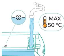
9 Riempite il serbatoio dell'acqua pulita con acqua del rubinetto fredda o tiepida almeno fino al livello AUTOCLEAN.
