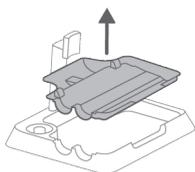
**2** Pladenj za po čiščenju operite pod tekočo vodo in ga pustite posušiti, šele potem ga namestite nazaj na postajo za shranjevanje.
