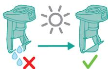
**21** Remplacez le filtre humide dans le réservoir d'eau sale.
