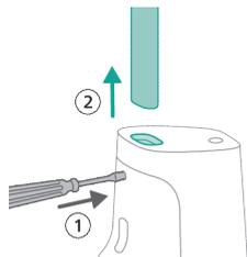
**1** Εισαγάγετε μια καρφίτσα/ένα ίσιο κατσαβίδι μέσα στην οπή στο κάτω μέρος της συσκευής και τραβήξτε τη λαβή.
