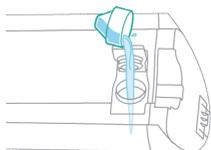
**⚠ Προσοχή:** Η Philips έχει δοκιμάσει αυτή τη συσκευή μόνο με καθαριστικό δαπέδου Philips Floor Cleaner XV1792. Άλλα απορρυπαντικά μπορεί να προκαλέσουν υπερβολικό αφρό, με αποτέλεσμα να μειωθεί η απόδοση της συσκευής και να προκληθεί δυσλειτουργία της. Το καθαριστικό δαπέδου XV1792 Philips Floor Cleaner είναι διαθέσιμο σε επιλεγμένες αγορές. Όταν χρησιμοποιείτε οποιοδήποτε άλλο κατάλληλο καθαριστικό δαπέδου, προσθέτετε το πολύ 15 ml στο δοχείο καθαρού νερού.
