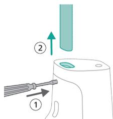
**2** Izvucite ručku iz uređaja dok istovremeno nastavljate gurati odvijač u otvor.
