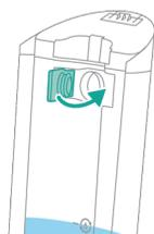
8 Aprire il coperchio di protezione del serbatoio dell'acqua pulita.
