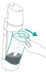
**15** Appuyez sur le bouton pour déverrouiller le réservoir d'eau sale et le retirer.
