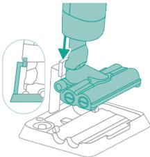
**2** Για να αποθηκεύσετε τη συσκευή, μπορείτε να την τοποθετήσετε στον σταθμό αποθήκευσης μετά τον καθαρισμό. Σύρετε τη συσκευή πάνω στη βάση συσκευής, ώστε το άκρο της βάσης της συσκευής να εισέρχεται μέσα στη συσκευή.
