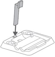
Για να χρησιμοποιήσετε τη λειτουργία AUTOCLEAN ή να αποθηκεύσετε και να φορτίσετε τη συσκευή στον σταθμό αποθήκευσης μετά τον καθαρισμό, θα πρέπει πρώτα να συναρμολογήσετε τον σταθμό κουμπώνοντας τη βάση της συσκευής στην πλάκα βάσης.
