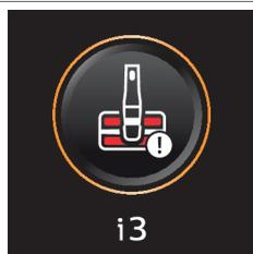
AquaSpin sprausla ir iesprūdusi. Tā ir apturēšana drošības nolūkos, ja kaut kas ir iesprūdis uzgalī (piemēram, barošanas kabelis vai rotaļlieta).
