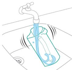
**18** Limpe o depósito água suja sob água corrente.
