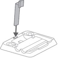
За да използвате функцията AUTOCLEAN или за съхранение и зареждане на уреда в станцията за последващо почистване и съхранение, трябва най-напред да сглобите станцията, като захванете държача на уреда в поставката.
