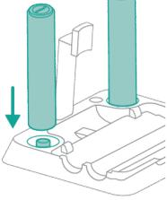
**24** Mikrofiber fırçaların kurumasını sağlamak için fırçaların açık uçlarını Temizlik Sonrası ve Saklama istasyonundaki ilgili yerlerine yerleştirin.
