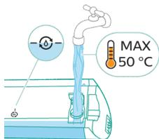
9 Napunite spremnik za čistu vodu hladnom ili mlakom vodom iz slavine barem do oznake AUTOCLEAN.
