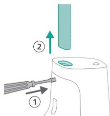
**1** Wsuń szpilkę / płaski śrubokręt w otwór z tyłu urządzenia i pociągnij uchwyt do góry.
