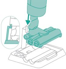
**2** Cihazı saklamak için bunu Temizlik Sonrası ve Saklama istasyonuna yerleştirebilirsiniz. Cihaz tutucunun ucu cihaza yerleşene kadar cihazı cihaz tutucuya doğru kaydırın.
