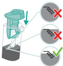
**i** Nota: Svuotate il serbatoio dell'acqua sporca se il livello dell'acqua si trova sopra il segno AUTOCLEAN. Altrimenti, potete saltare i passaggi seguenti e andare direttamente al punto 6.
