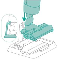
**2** Pour ranger l'appareil, vous pouvez le placer sur la station de rangement post-nettoyage. Faites glisser l'appareil sur son support de manière à ce que l'extrémité du support s'insère dans l'appareil.
