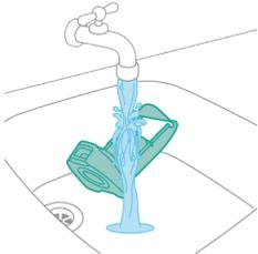
**20** Laat het natte filter van het vuilwaterreservoir en het waterstroomelement volledig drogen voordat u deze terugplaatst op het vuilwaterreservoir.
