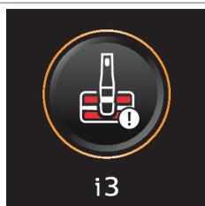
La brosse AquaSpin est bloquée. Il s'agit d'un dispositif d'arrêt de sécurité qui se déclenche si quelque chose est coincé dans la brosse (un câble d'alimentation ou un jouet, par exemple).
