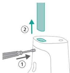
**2** Scoateți mânerul din aparat în timp ce continuați să împingeți șurubelnița în orificiu.
