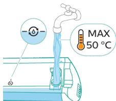
9 Encha o depósito água limpa com água corrente fria ou morna, no mínimo, até à indicação AUTOCLEAN.
