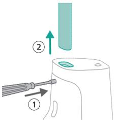
**2** Vytiahnite rukoväť zo zariadenia, pričom naďalej tlačte skrutkovač do otvoru.
