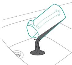
18 Curățați rezervorul de apă murdară sub jet de apă.
