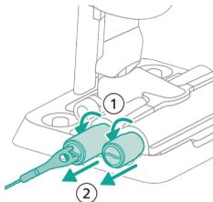
**23** Okrenite četke od mikrovlakana u smjeru suprotnom od smjera kretanja kazaljke na satu (1) i odvojite ih od mlaznice AquaSpin (2).
