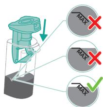
**i** Uwaga: Opróżnij zbiornik brudnej wody, gdy poziom wody przekracza oznaczenie AUTOCLEAN. W przeciwnym przypadku możesz pominąć następane kroki i przejść do kroku 6.
