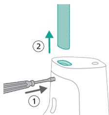
**2** Izvucite dršku iz aparata nastavljajući da gurate odvijač u rupu.
