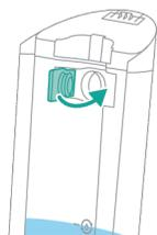
11 Coloque o depósito água limpa novamente no aparelho.
