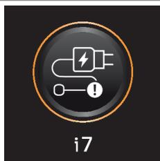
Den forkert oplader er tilsluttet. Brug kun den medfølgende adapter ved opladning af apparatet. Brug kun 34 V-adapter S036-1A340100HE. Nummeret på den tilsvarende adapter findes på adapteren.
