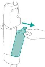
**1** Pritisnite gumb navzdol, da odklenete posodo za čisto vodo in jo odstranite.
