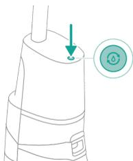
**13** For å starte AUTOCLEAN-syklusen trykker du på AUTOCLEAN-knappen. Hvis du ser en svart skjerm, trykker du på av/på-knappen først for å aktivere skjermen.
