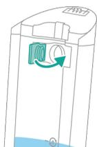
11 Vratite rezervoar za čistu vodu u uređaj.
