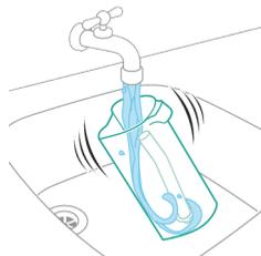
**18** Zbiralnik za umazano vodo očistite pod tekočo vodo.
