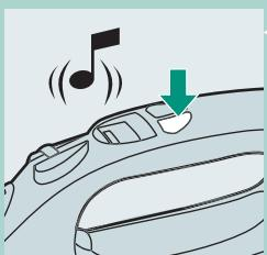
**7** Ha egy alacsonyabb vasalási hőfokot szeretne kiválasztani, csak nyomja meg a - vezérlőgombot a hőfok csökkentéséhez. Egy rövid sipolás jelzi, hogy a hőmérséklet beállítása megváltozott.
