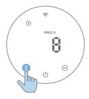
Com o sensor da luz, o painel de controlo pode ligar, desligar ou escurecer automaticamente de acordo com a luz ambiente. O painel de controlo estará desligado ou escurecido quando a luz ambiente estiver escura. Pode tocar em qualquer botão para ativar todas as luzes. Em seguida, se não tiver de realizar mais nenhuma operação, todas as luzes serão desligadas ou escurecidas novamente de acordo com a luz ambiente.
