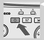
No modo de stand-by o consumo energético é inferior a 1Wh. Para ligar a máquina, pressione esta tecla (se o interruptor geral na parte traseira da máquina estiver na posição "I"). Se a caldeira estiver fria, a máquina executa um ciclo de enxaguamento.
