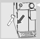
2 Retire o Batedor de leite clássico do tubo de vapor/água quente.
