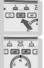
Pressione a tecla " para iniciar o ciclo. A máquina procede ao carregamento automático do circuito com uma saída reduzida de água do Batedor de leite clássico.
