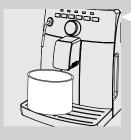
6 Posicione um recipiente com capacidade suficiente (1,5 l) sob o tubo de vapor/água quente e o distribuidor.
