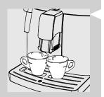
Sob o distribuidor podem ser colocadas duas chávenas, grandes/pequenas, para distribuir simultaneamente dois cafés.
