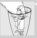
2 Retire o filtro de água "INTENZA+" da embalagem, mergulhe-o na posição vertical (com a abertura para cima) em água fria e pressione delicadamente os lados para que saiam as bolhas de ar.
