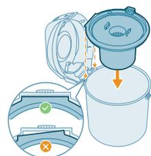
11 正确安装旋涡溢流管，确保其牢固贴在集尘桶的边缘，如图所示。
