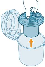
4 用手抓住兩個支架，將渦漩鏡從集塵桶中直接拉出。
