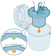
6 ตัดตั้งวอร์เท็กซ์ฟายเดอร์อย่างถูกต้องโดยตรวจสอบให้แน่ใจว่าแน่นพอดีกับขอบถังเก็บฝุ่น ดังที่แสดงในภาพประกอบ
