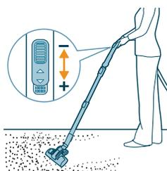
在吸尘过程中，您可以通过手柄上的吸力控制滑块来调节吸力大小。
