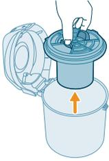
4 จับตัวยึดทั้งสองด้วยมือของคุณแล้วดึงวอร์เท็กซ์ฟายเดอร์ขึ้นตรงๆ จากถังเก็บฝุ่น
