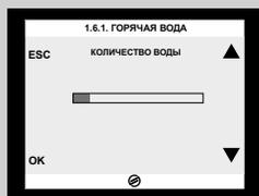
Регулируя полосу на дисплее с помощью кнопок прокрутки "▼" или "▲", можно выбрать количество подаваемой горячей воды. Нажмите кнопку "ОК" для подтверждения настройки.
