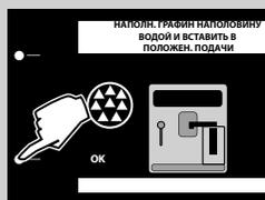
**11** Опорожните графин для молока и наполните его свежей водой. Вставьте его обратно в машину. Нажмите кнопку "ОК".
