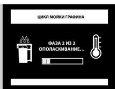
**16** Машина начнет подавать воду как из устройства подачи кофе, так и из устройства подачи молока. Полоска позволяет отображать прогресс выполнения цикла.
