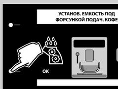
**6** Установите емкость (1,5 л) под устройство подачи кофе. Нажмите кнопку "OK" для запуска цикла очистки.
