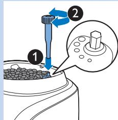
**1** Міцно натисніть регулятор налаштування ступеня помелу (1), а потім повертайте його на одну поділку за раз (2). Можна вибрати один із 5 різних налаштувань ступеня помелу. Що менша точка, то міцніша кава. Різниця стає помітною після приготування 2-3 чашок кави з новим налаштуванням.
