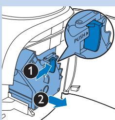
**4** Натисніть кнопку PUSH (1) і потягніть за ручку блока заварювання (2), щоб вийняти його з апарату.
