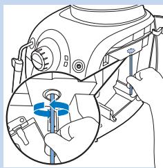
**5** Ретельно почистіть сопло виходу кави за допомогою ручки ложки або іншого кухонного пристрія з круглим кінцем.
