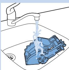
**6** Промойте внешнюю поверхность варочной группы под струей теплой воды.
