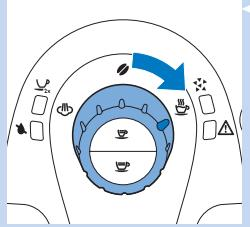
**5** Поверните диск управления так, чтобы он указывал на значок горячей воды.
