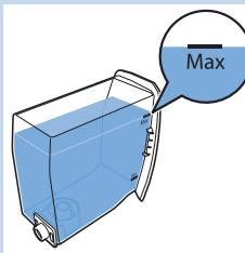
**3** Наповніть резервуар холодною водою з-під крана до позначки MAX.
