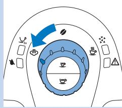
**5** Погрузите классический капучинатор или трубку выхода горячей воды/пара в молоко, поверните диск управления так, чтобы он указывал на значок пара. Готовьте молочную пенку плавными круговыми движениями, приподнимая и опуская кувшин.
