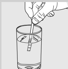
**1** 将咖啡机自带的水质硬度试纸在水中浸泡 1 秒。
