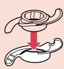
**1** Снимите с ножа защитный колпачок.
