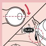
Motorová jednotka, nádoba a její víko jsou opatřeny značkami. Přístroj lze zapnout jen tehdy, když je značka na motorové jednotce přesně proti značce na nádobě.
