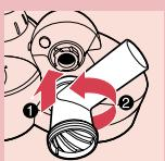
**1** Montați carcasa angrejului pe blocul motor. Dacă accesorile sunt montate corect veți auzi un clic.
