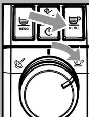
7 Når tasten "MEMO" lyser med fast lys vrir du velgeren i klokkeretningen fram til punktet "MEMO". Nå føres avkalkingsmiddelet ut fra damp-/varmtvannsrøret med jevne mellomrom.
