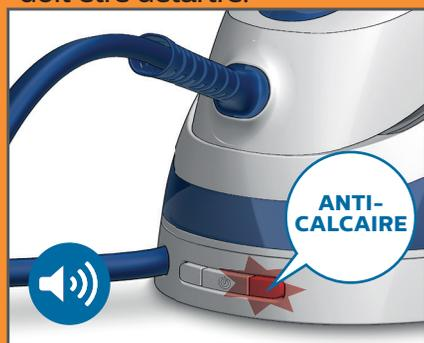
Détartrez votre appareil lorsque le voyant de détartrage clignote et que l'appareil émet des signaux sonores.
