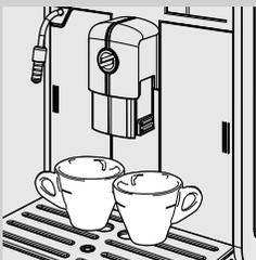
Sob o distribuidor de café podem ser colocadas duas chávenas para distribuir simultaneamente dois cafés.
