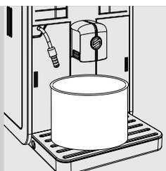
**6** Posicione um recipiente com capacidade suficiente (1,5 l) sob o tubo de vapor/água quente e sob o distribuidor de café.
