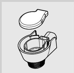
**21** Remova a tampa de borracha conforme apresentado na figura.
