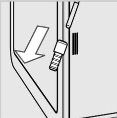
**18** Remova a protecção de borracha do tubo de vapor.
