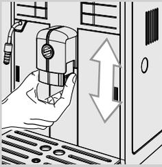
O distribuidor de café pode ser ajustado em altura para melhor se adaptar às dimensões das chávenas que deseja utilizar.
