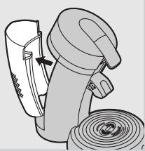
2 Remplissez le réservoir jusqu'au niveau **MAX** avec de l'eau fraîche, puis remettez-le en place.
