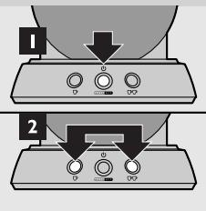
**4** Drücken Sie den Ein-/Ausschalter  $\Theta$  (1). Drücken Sie anschließend die 1-Tasse-Taste  $\Theta$  und die 2-Tassen-Taste  $\Theta\Theta$  kurz gleichzeitig (2). Das Gerät entnimmt automatisch Wasser aus dem Wasserbehälter. Während dieses Vorgangs tritt Wasser aus dem Kaffeeausguss aus. Anschließend schaltet sich die Maschine automatisch ab. Während des Durchspülens ist das Gerät lauter als beim Brühen von Kaffee.
