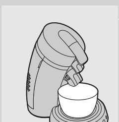
**8 Placez un bol (d'une capacité minimale de 1 500 ml) sous les orifices d'écoulement du café pour recueillir l'eau.**
