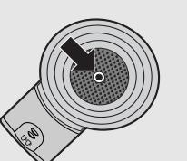
**7** Reinigen Sie die Padhalter in heißem Wasser, dem Sie bei Bedarf etwas Spülmittel zufügen können, oder im Geschirrspüler.
