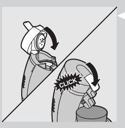
**6** Schließen Sie den Deckel und den Verschlusshebel.
