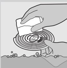
**6** Halten Sie das Tassentablett in der Hand, wenn Sie es mit heißem Wasser reinigen - bei Bedarf mit etwas Spülmittel.
