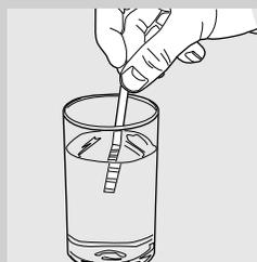
**1** Mergulhe em água a tira de teste de medição da dureza da água fornecida com a máquina durante 1 segundo.
