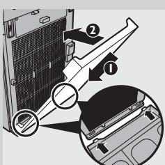
**9** 若要重新蓋上正面護板，先將正面護板底部的二個扣鉤裝入產品底部的開口 (1)，然後將護板推入產品機體 (2)。
