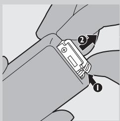
本產品隨附遙控器專用電池 (型號 CR2025)。請先將電池裝入遙控器中，再開始使用本產品。
