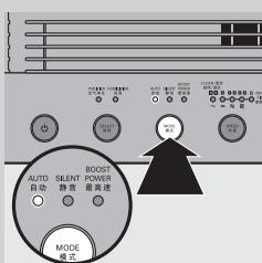
当产品在 AUTO (自动) 模式下运行时, 它将根据内置空气质量传感器感应的空气质量来自动调节风速。
