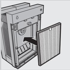
**5** 将过滤网 4 (HEPA 过滤网) 放回产品内部。
