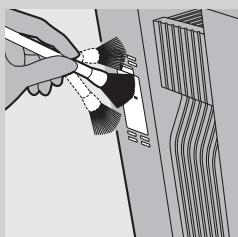
每 2 個月清潔空氣品質感測器及濕度感測器，確保產品發揮最佳效果。如果在佈滿灰塵的環境中使用本產品，就要更常清潔空氣品質感測器。
