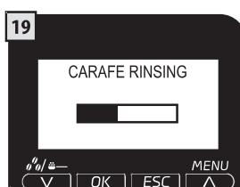
Sākas skalošanas cikls. Skala norāda cikla progresu. Cikla beigās kafijas automāts atgriežas dzērienu gatavošanas izvēlnē.
